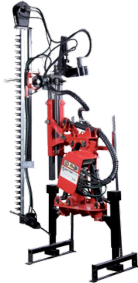
Macchina progettata per mantenere controllata la crescita vegetativa della pianta. Questa, come tutta la famiglia delle cimatrici ID, nasce con un sistema eccentrico montato sulle barre di taglio che permette un movimento 30/70% delle lame. Ciò permette sempre un taglio netto della vegetazione combinato ad una velocità di utilizzo molto elevata (10-12 km/h).
