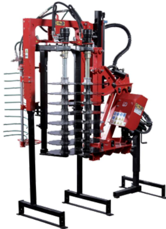
Pre-potatrice frontale per taglio e rimozione dei sarmenti tra i filari, dotata di serie di un sistema di oscillazione del modulo di taglio che garantisce una costante verticalità della testata di lavoro. La colonna decentrata permette un'ottima visibilità e una maggiore vicinanza al filare, consentendo inoltre l'utilizzo di trattori di bassa potenza.
