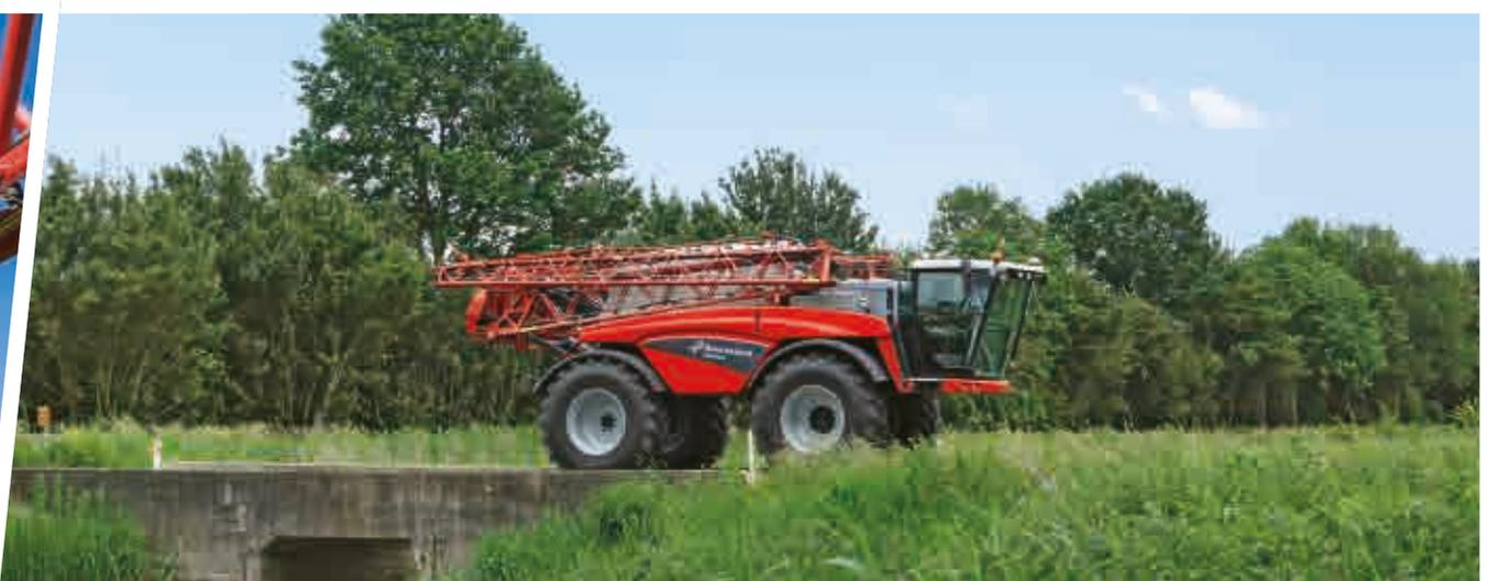
Il modello HSS è l'ideale per utilizzi professionali. La sua particolare costruzione in acciaio Domex a triangolo rende la barra robusta e protegge totalmente gli ugelli. La barra è sospesa tramite un robusto parallelogramma che garantisce la massima versatilità in ogni tipo di coltura.
