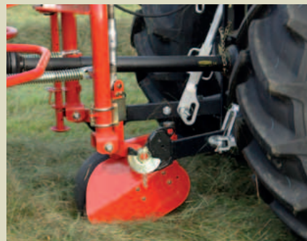
In opzione questo andanatore può essere provvisto di una terza ruota, facilmente regolabile dalla cabina del trattore.
