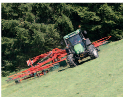
Il sistema di sterzata automatico assicura grande manovrabilità in fondo campo e durante il trasporto.
