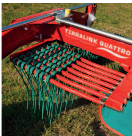
Kverneland Taarup 9476 C: facile riposizionamento dei denti per il trasporto.
