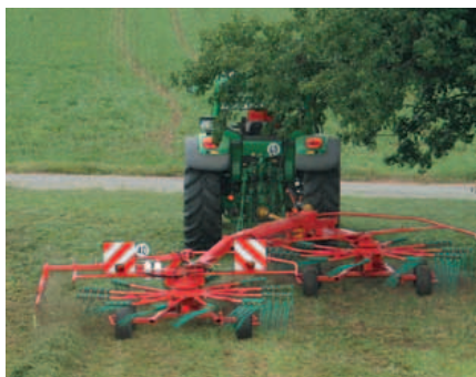
SideShift a destra - ideale per sorpassare ostacoli come alberi a bordo campo.
