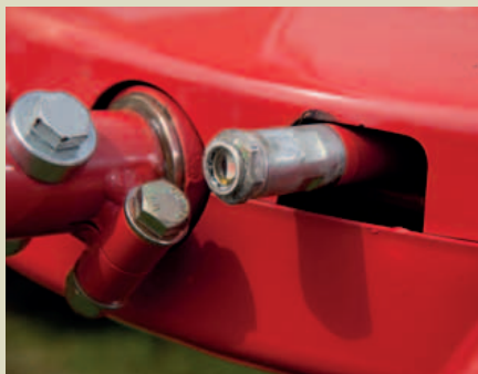
I livelli di olio sono ben visibili da una finestrella.
