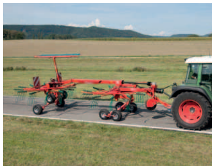
Sospensioni degli assali tirate per eccellenti proprietà di avanzamento, a bassa richiesta di potenza.
