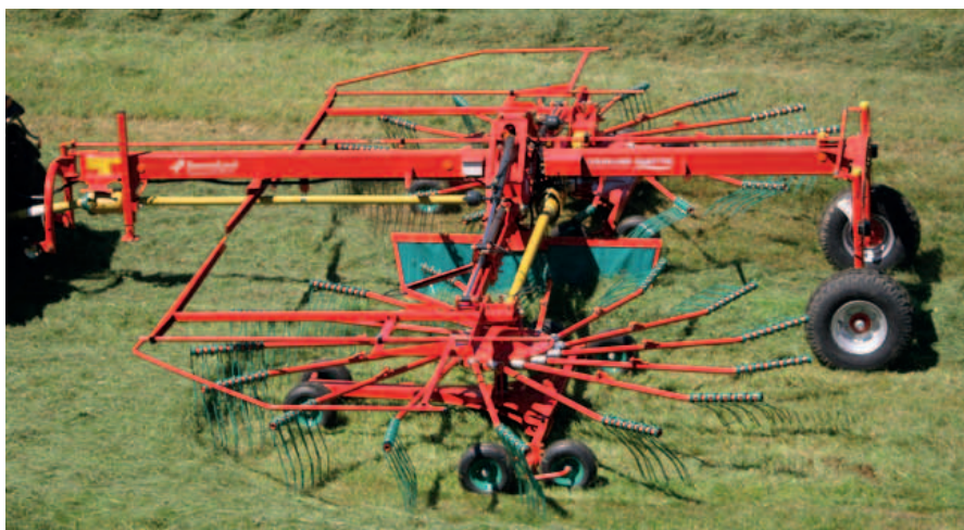
L'andatore Kverneland Taarup 95110 C dispone del sistema TerraLink Quattro, che controlla l'aderenza al terreno in tre dimensioni e offre quindi un ottimo
