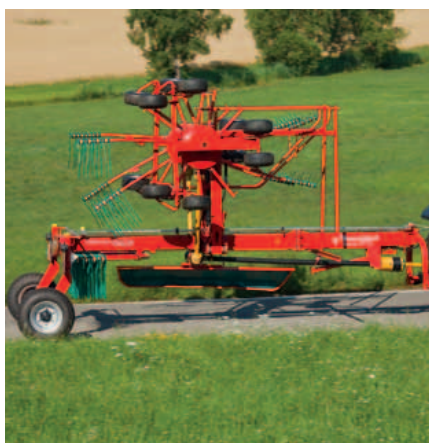
Conversione per il trasporto regolata dalla cabina del trattore, con ripiegamento idraulico del deflettore d'andana. Sul modello 9476 C le braccia portadenti sono rimovibili in modo da avere un'altezza di trasporto ridotta.
