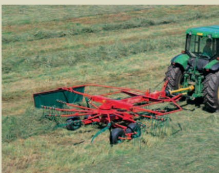
Kverneland Taarup 9442 T con larghezza di lavoro da 4,20 m.
