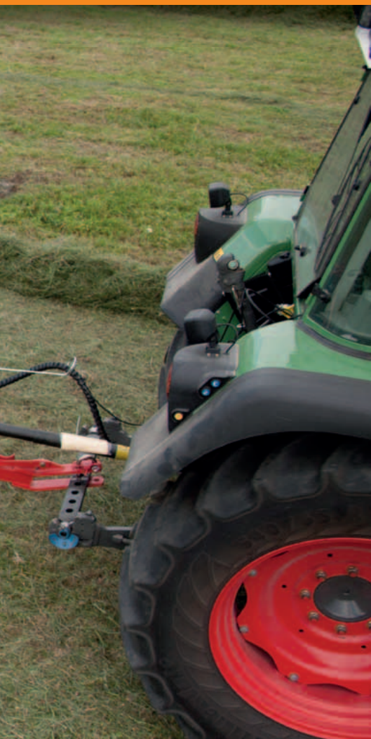
SideShift a destra - ideale per sorpassare ostacoli come alberi a bordo campo.
