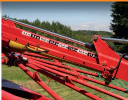
Regolazione idraulica della larghezza di lavoro fra 9,60 e gli 11 m.
