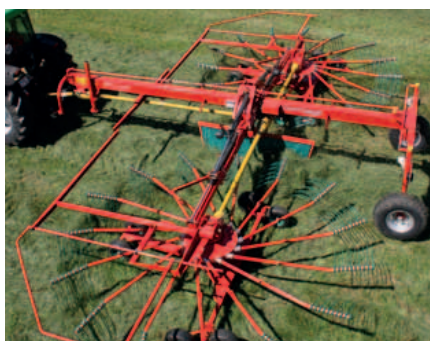
Con 15 braccia portadenti con 4 denti DUO ciascuno, l'andatore 95110 C offre massime performance a velocità elevate, anche a basso regime.
