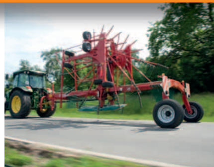
Per ottenere un'altezza di trasporto inferiore ai 4 m, le braccia portadenti possono essere rimosse e posizionate sul telaio portante.
