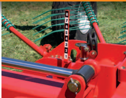
Regolazione idraulica dell'altezza dei rotori per un migliore adattamento a diverse altezze delle stoppie o a diverse condizioni del terreno.
