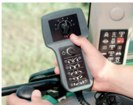
Il box di controllo posizionato nella cabina del trattore monitora tutte le funzioni necessarie per il lavoro, come il sollevamento e regolazione dei rotori e della larghezza di lavoro.
