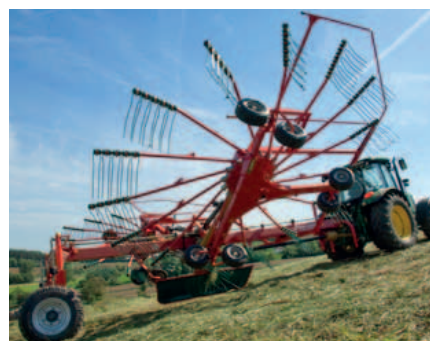
I due rotori vengono sollevati idraulicamente a fine campo, per assicurare un'ottima luce da terra durante la svolta.
