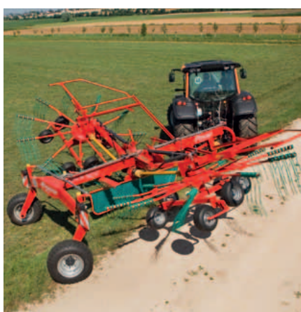
Perfetta manovrabilità a fine campo grazie al sistema idraulico di sollevamento QuickLift.
