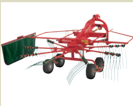
Andanatore Kverneland Taarup 9032 con larghezza di lavoro da 3,20 m.
