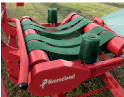
Tavola girevole con due rulli laterali per garantire la massima stabilità della palla e una rotazione continua durante l'avvolgimento.
