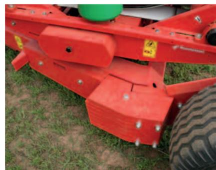
Per una garanzia di stabilità anche con le balle più pesanti, è possibile fissare dei contrappesi extra sul lato sinistro della macchina.
