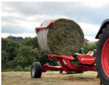
Braccio caricante azionato idraulicamente, con un'altezza ridotta di carico per un trasferimento veloce della palla sulla piattaforma.
