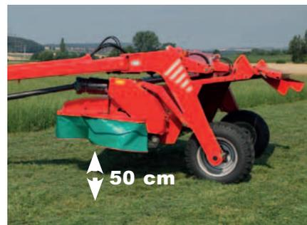
La particolare struttura del carrello offre una luce da terra di ben 50 cm.
