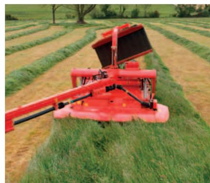
Il tappeto è sospeso idraulicamente per ridurre il carico degli urti sul telaio principale e offrire una formazione d'andana più omogenea.
