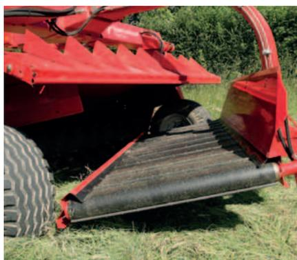
La cinghia di trasmissione scanalata assicura un trasporto preciso e omogeneo anche dei prodotti più pesanti.
