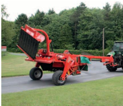
Per il trasporto, i modelli CT/CR vengono disposti in una posizione centrale e posteriore al trattore.
