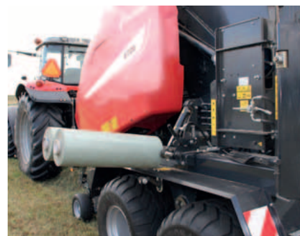
I rulli porta film vengono abbassati idraulicamente per una facile e rapida sostituzione dei rotoli.
