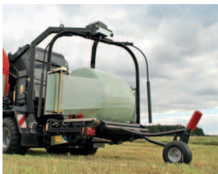
Avvolgitore doppio satellitare con 2 pretensionatori e 4 cinghie senza fine.
