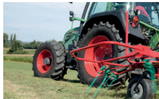
Modello Kverneland Taarup 8452 con una larghezza di lavoro da 5,20 m.
