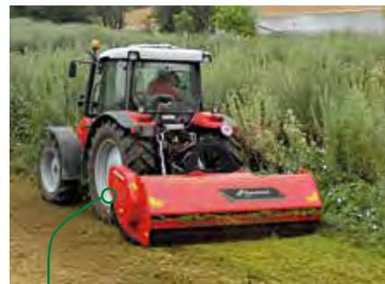
La serie **FXN** è stata ideata per trinciatura di grandi masse di residui colturali, mais, sorgo, girasole, etc...ed è disponibile in diverse misure da 1.95m a 3.20m di larghezze di lavoro. Scelta tra rullo e ruote pivottanti per il controllo della profondità.
