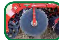
I dischi laterali regolabili compattano la banda lavorata contenendone il terreno.
