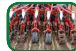
Le ruote pressatrici ricompattano il terreno
