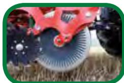
I dischi frontali aprono il solco tagliando i residui, che poi vengono rimossi dalla banda tramite ruote dentate.
