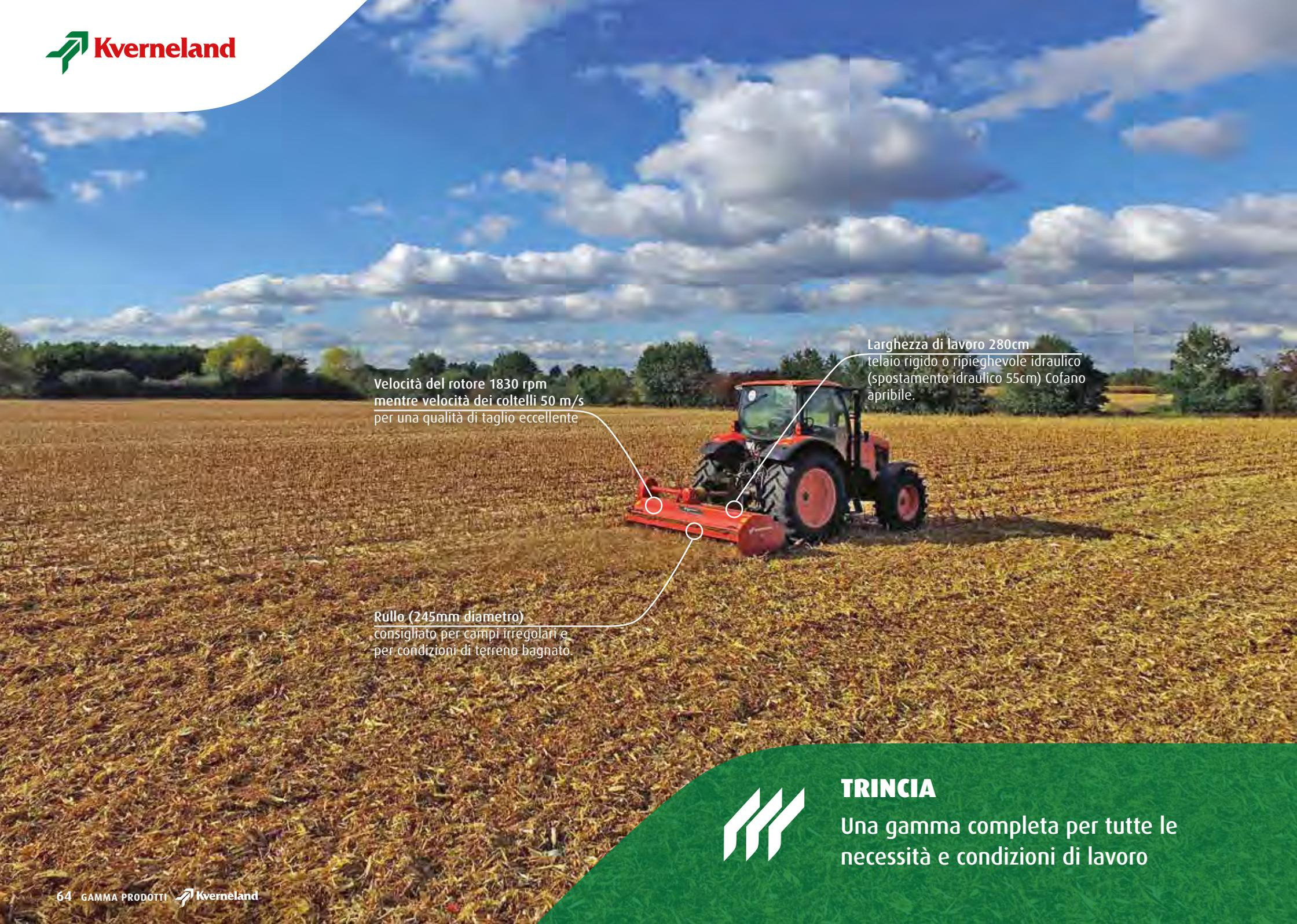
Velocità del rotore 1830 rpm
