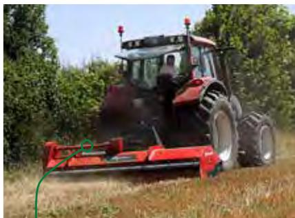
Il nuovo modello **FRH** è dotato di spostamento idraulico ed è ideale per trattori di media/alta potenza disponibile da 2.35m a 3.20m di larghezza di lavoro.
