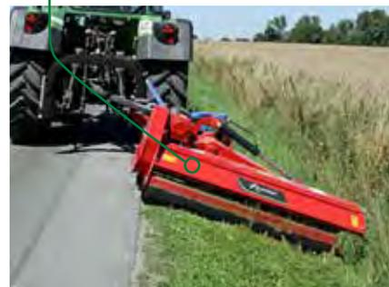
**FRO e FRD** sono trincia dotati di doppio attacco, utilizzabili sia frontalmente che posteriormente. Standard spostamento idraulico.
