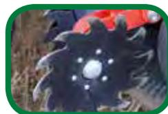
Le trash wheels rimuovono ogni tipo di residuo o zolle dalla banda di semina lasciandola perfettamente pulita.
