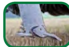
Particolari punte dissodano il terreno a profondità fino a 30cm. Tre differenti ancore a seconda della tipologia di terreno garantiscono velocità di lavoro fino a 12km/h.
