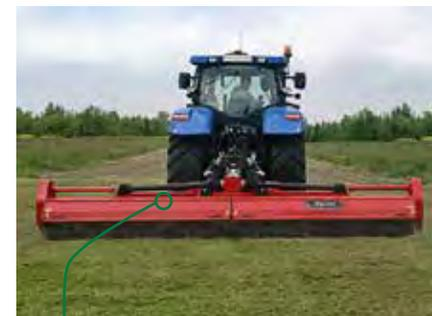
Il modello **FXF** pieghevole idraulico è disponibile in due versioni da 5.60m e 6.40m di larghezza di lavoro, adatto per lavori intensivi e trattori fino a 260 Hp.
