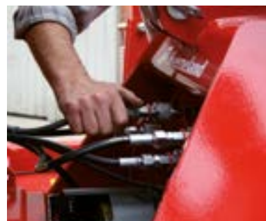
Interfaccia delle connessioni idrauliche ed elettriche all'interno della testata d'attacco dell'erpice rotante.
