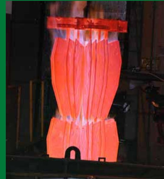
***Il processo di indurimento (carburizzazione) di Kverneland dura 12 ore e permette la creazione di 2 strati a durezze differenziate per corpo.***
