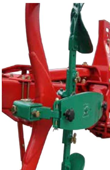
L'aratro Kverneland i-Plough 2500 è fornito con le nuove buri AERO. Sono più alte delle buri standard e migliorano il flusso del suolo. Con entrambe le misure di passo (85 e 100 cm), i residui sono espulsi limitando gli intasamenti.
