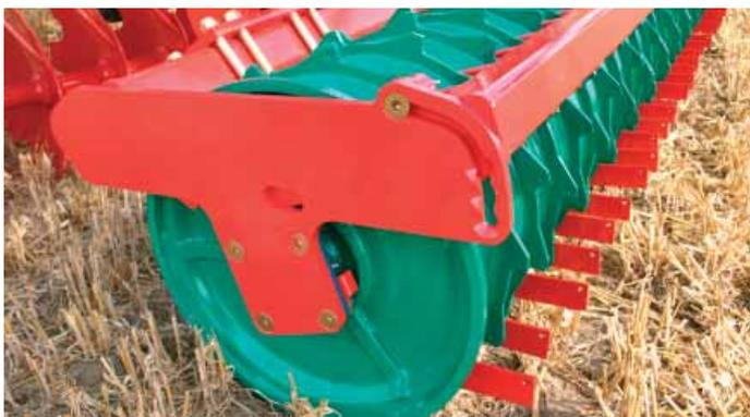
Il nuovo rullo **Kverneland Actipack** è consigliato in terreni con impasto medio o tenace. L'integrato sistema di sminuzzamento posto nella parte inferiore del rullo contribuisce ad un ulteriore processo di finitura, preparando direttamente il terreno per la successiva semina. E' possibile regolare il grado di affinamento del terreno tramite un semplice registro posto nella parte superiore del rullo. Il rullo Actipack può essere accoppiato ad una fila di dischi anteriore.
