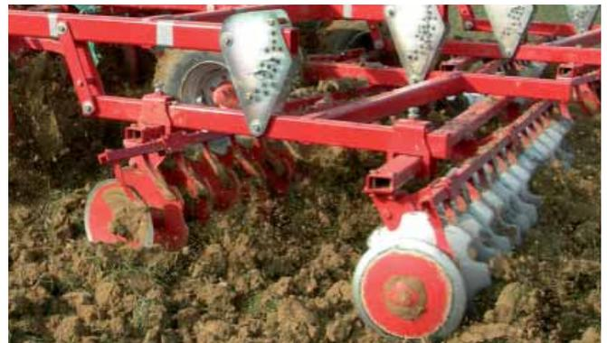
Per una miscelazione costante e omogenea di tutti i residui colturali, Kvernelad offre la doppia fila di dischi a X con diametro 510 mm. La profondità di lavorazione viene regolata tramite le due ruote anteriori, la regolazione dell'angolo di penetrazione è regolabile meccanicamente.
