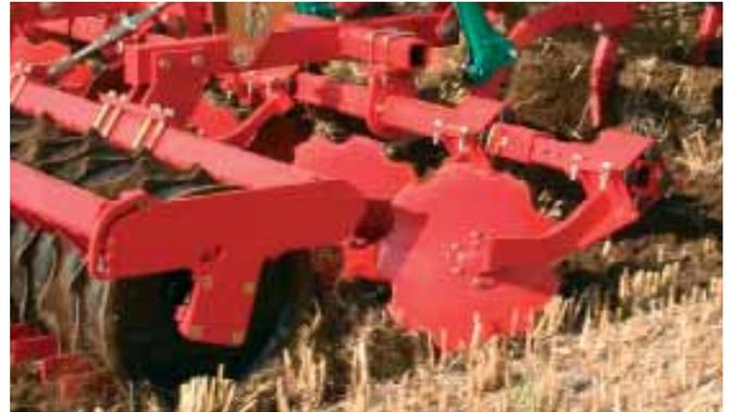
Come dotazione standard i dischi livellatori anteriori dispongono di un sistema di fissaggio su silent block che assicura protezione al telaio degli stessi. La loro forma dentata garantisce nello stesso momento affinamento e livellamento del terreno.
