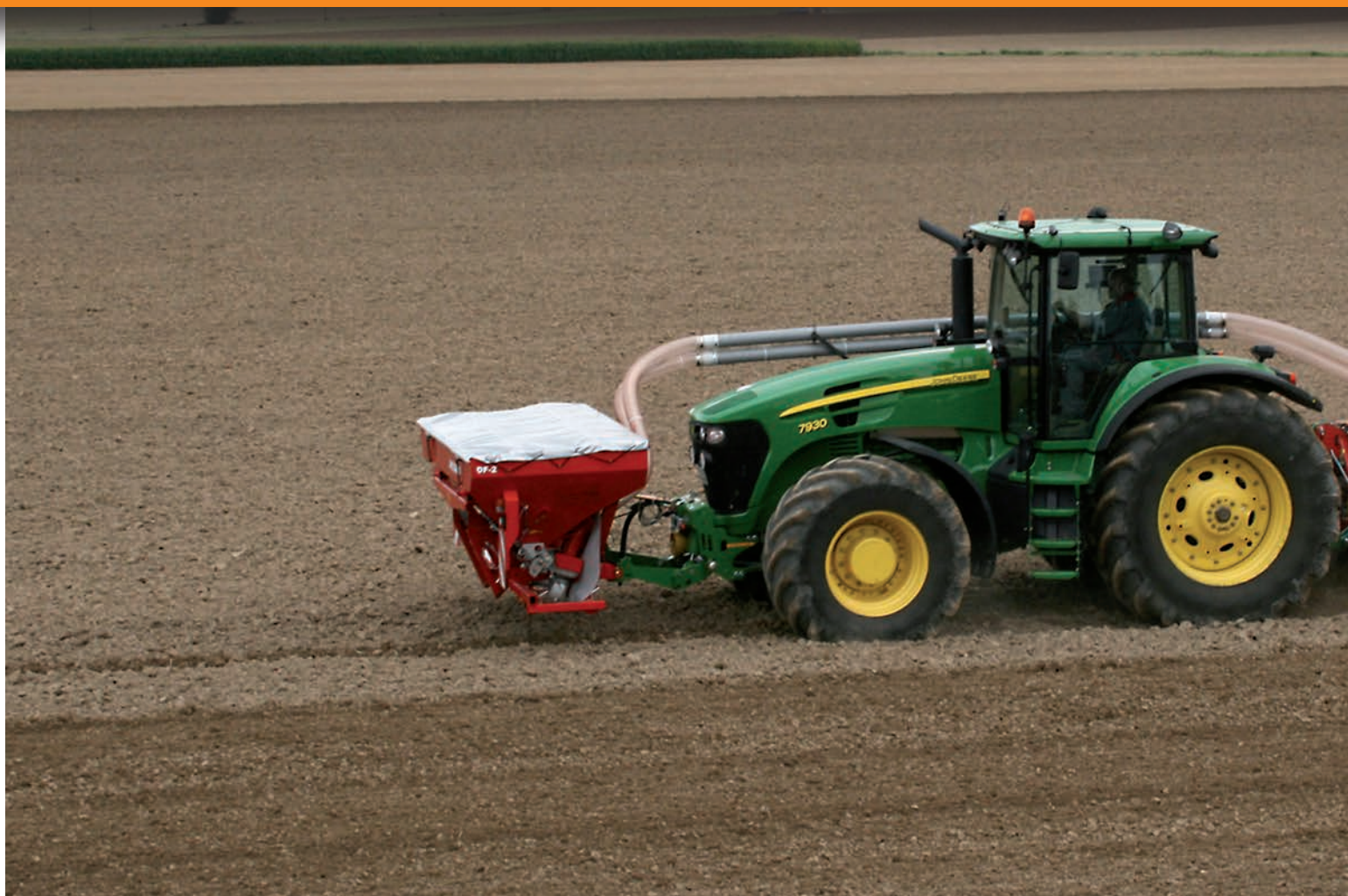
Kverneland NG-S F35 con barra di semina a doppio disco CX e serbatoio frontale Kverneland Accord DF-2
