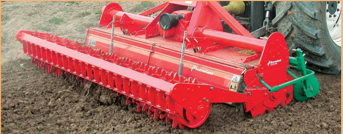
Le frese Kverneland possono essere equipaggiate con rulli Packer o rulli a gabbia con diametro 500 mm. (vedi foto a lato) per un'ottima preparazione del letto di semina.
