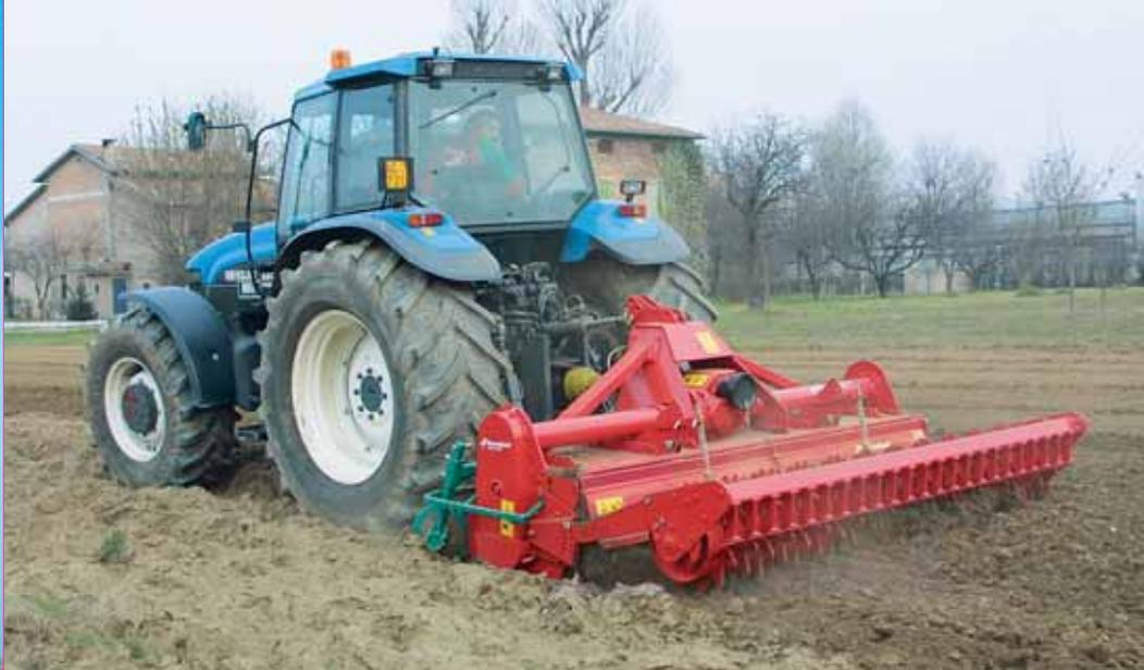
Il modello Kverneland GS 250 può essere equipaggiato (in opzione) con diversi tipi di rulli posteriori, rompitraccia, doppie flange standard e attacco seminatrice posteriore per l'utilizzo in combinata.
