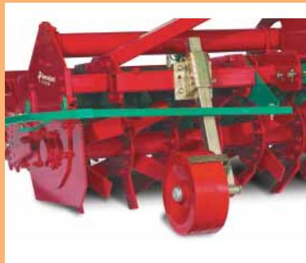
Ruote anteriori in acciaio, generalmente utilizzate per l'impiego della fresa con sollevatore frontale.
