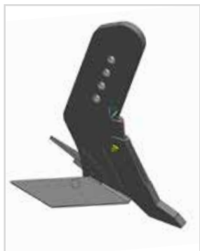
Il dente a basso disturbo LD (Low Disturbance) apre in profondità senza disturbare in superficie. L'apertura creata dal dente si richiude immediatamente dopo il passaggio dissodante.
