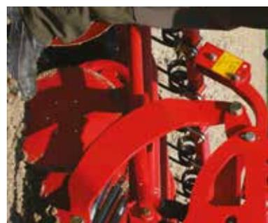
La regolazione meccanica della pressione del falcione è standard, mentre la versione idraulica è opzionale.
