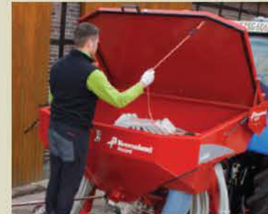
Struttura della tramoggia per facili operazioni, protezione del seme e della testata di distribuzione.
