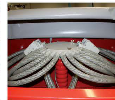
Testata di distribuzione interna alla tramoggia.
