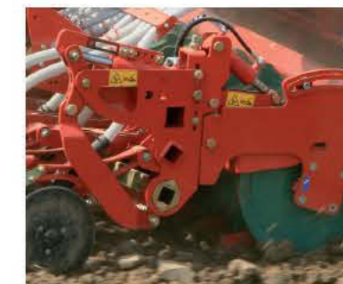
La barra di semina è collegata direttamente al telaio del rullo compattatore.
