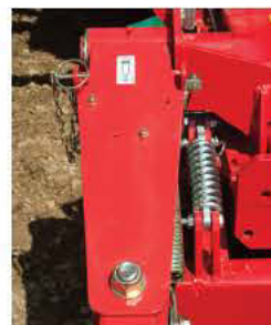
Protezione dei tracciafile dal sovraccarico.
