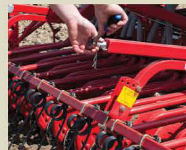
In base alle diverse condizioni del terreno è possibile regolare manualmente la pressione e l'angolazione degli erpici.
