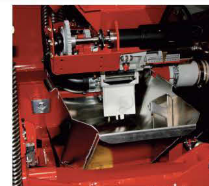
La calibratura è semplificata grazie al posizionamento brevettato del dosatore.
