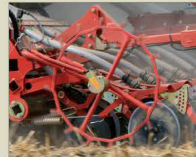
Ruota dentata con sistema di frenatura integrato per una distribuzione senza sprechi, specialmente a fine campo.
