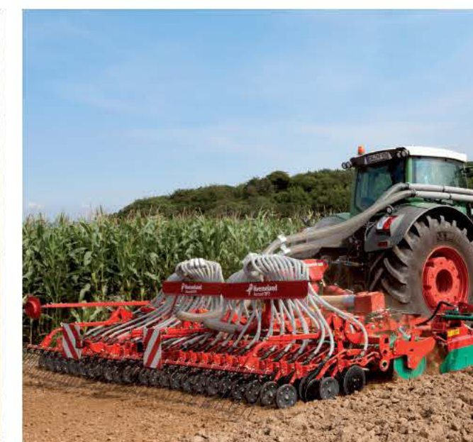
L'ottimo posizionamento dei tubi di conduzione del seme assicura un'eccellente distribuzione.
