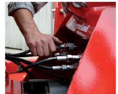
Interfaccia delle connessioni idrauliche ed elettriche all'interno della testata d'attacco dell'erpice rotante.
