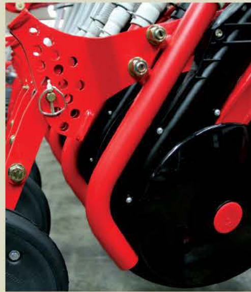
Falciatore CX-II con doppia entrata per la distribuzione di fertilizzante (tubo rosso) e semina (tubo nero), in una sola passata.
