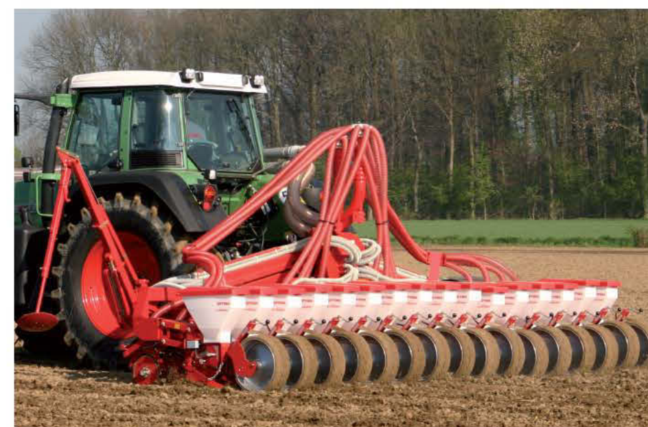
In combinazione con una seminatrice di precisione, la tramoggia frontale DF-2 può essere usata per la sola distribuzione di fertilizzante (fino a 16 file)
