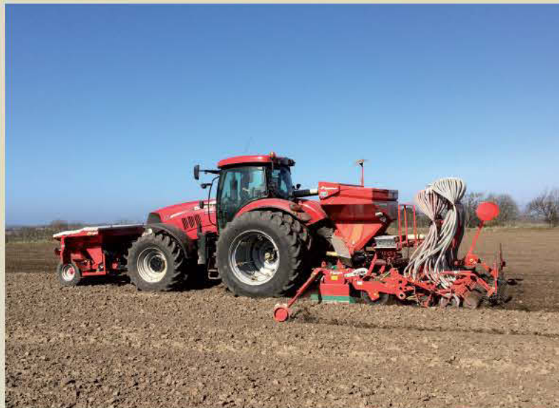
La seminatrice i-drill PRO in combinazione con la tramoggia frontale DF-1. Quest'ultima sarà adibita alla distribuzione di concimazione, mentre la tramoggia dell'i-drill PRO alla semina.
