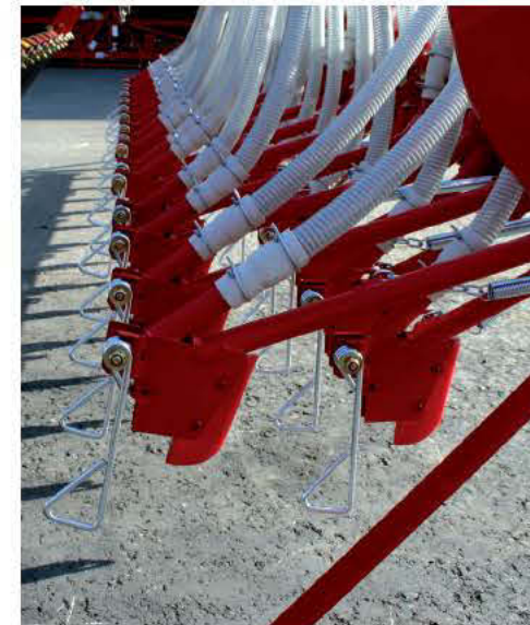
Falciatore Suffolk con doppia entrata per l'applicazione di fertilizzante e semina.
