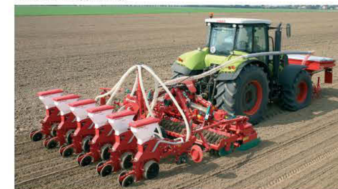
La tramoggia della DF-1 utilizzata per la distribuzione di fertilizzante durante la semina di precisione con un massimo di 8 file.
