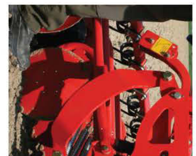
La regolazione meccanica della pressione del falciatore è standard, mentre la versione idraulica è opzionale.
