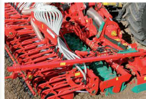
Il marcafile pieghevole idraulicamente, con bullone di protezione dal sovraccarico, è montato direttamente sulla cassa dell'erpice rotante.
