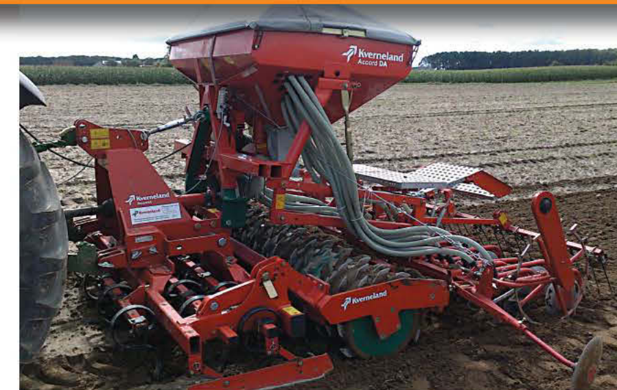
DA, larghezza di lavoro 3 m, in combinazione con il coltivatore Access.
