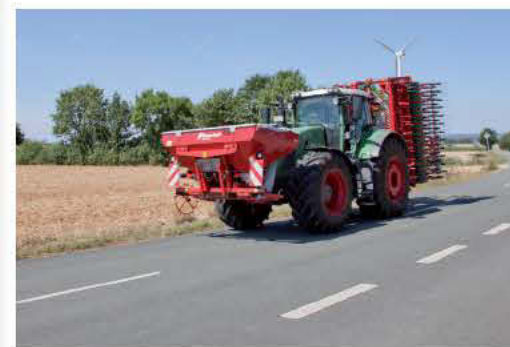
Richiudibile a una larghezza di 3.0 metri per un sicuro trasporto su strada.
