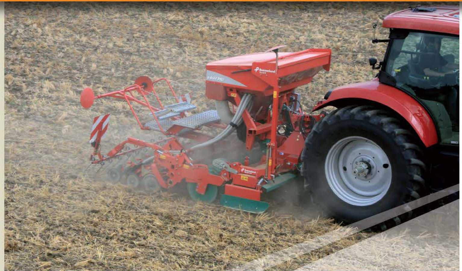
Struttura della tramoggia per facili operazioni, protezione del seme e della testata di distribuzione.
