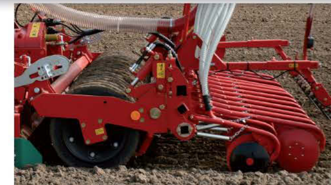
Diretta connessione della barra di semina al telaio e kit per il sollevamento della barra di semina (opzionale).
