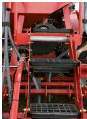
La nuova scaletta con ringhiera garantisce facile accesso al serbatoio in grande sicurezza.
