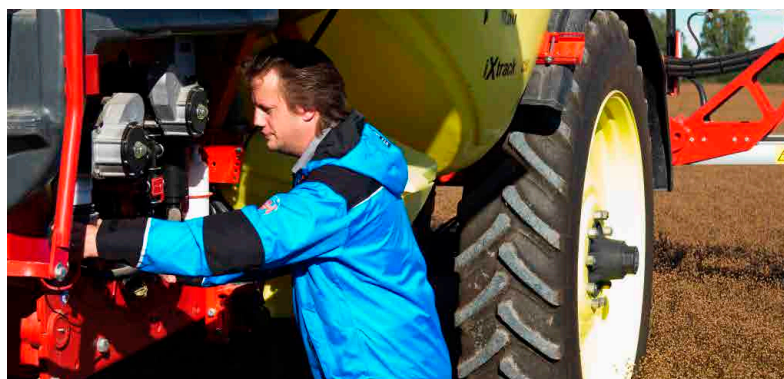
Il sistema di pulizia Kverneland iXclean Pro permette, premendo un bottone, di attivare le varie opzioni: risciacquo impianto, riempimento, miscelazione, irrorazione e risciacquo serbatoio.
