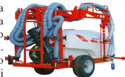
**EuroVid 4.0 Plus** è stato disegnato per trattamenti ad alta pressione con bassi consumi. Le gocce formate dall'aria non si disperdono né per deriva, né per evaporazione e la distanza dalle piante rimane sempre costante.
