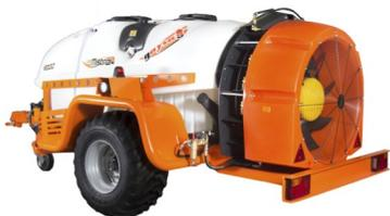
Il modello "**Mistral Andalusia**" è stato progettato per lavorare su terreni difficili e con molto dislivello. Equipaggiato con il ventilatore "**Mistral Ø900 mm**" è l'ideale per colture con spazi di lavoro ampi come gli oliveti.
